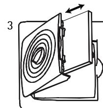
2. Вставьте угольный фильтр в крепление на стенке решетки (3) и прижмите решетку таким образом, чтобы она механически зафиксировалась.
