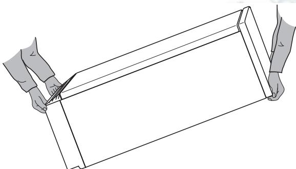
2. Чтобы задвинуть холодильник на предназначенное ему место, осторожно надавите на дверцу сверху и слегка отклоните холодильник назад. Таким образом вес холодильника будет приходиться на задние колесики, благодаря чему Вы сможете его легко двигать.
