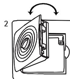
3. Вставьте новый угольный фильтр в крепление на стенке решетки и прижмите решетку таким образом, чтобы она механически зафиксировалась.
